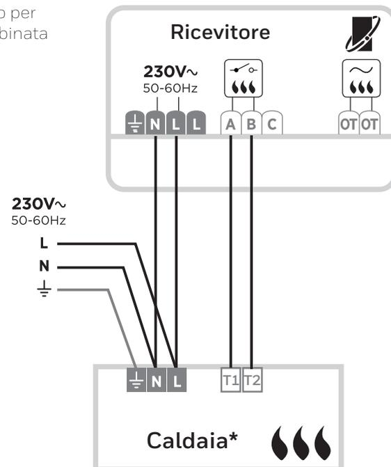
C) Cablaggio per caldaia OpenTherm
