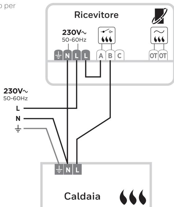
B) Cablaggio per caldaia combinata
