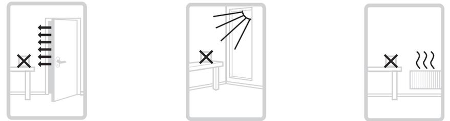
Il termostato T6R non deve essere collocato presso correnti d'aria o fonti di calore né esposto alla luce solare diretta.
