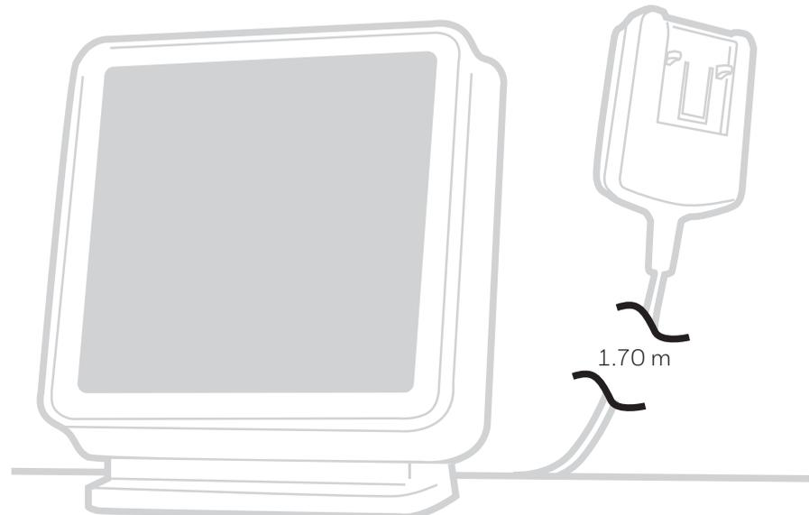
Scegliere la spina adatta. Collocare il termostato su una superficie orizzontale e uniforme, e inserire la spina in una presa di corrente.
